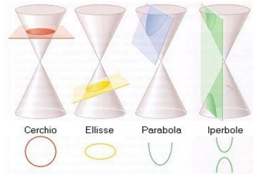
L'*iperbole* fa parte di un insieme di curve (circonferenza, parabola, ellisse) chiamate *coniche*, perché si possono ottenere tagliando un cono con un piano.
