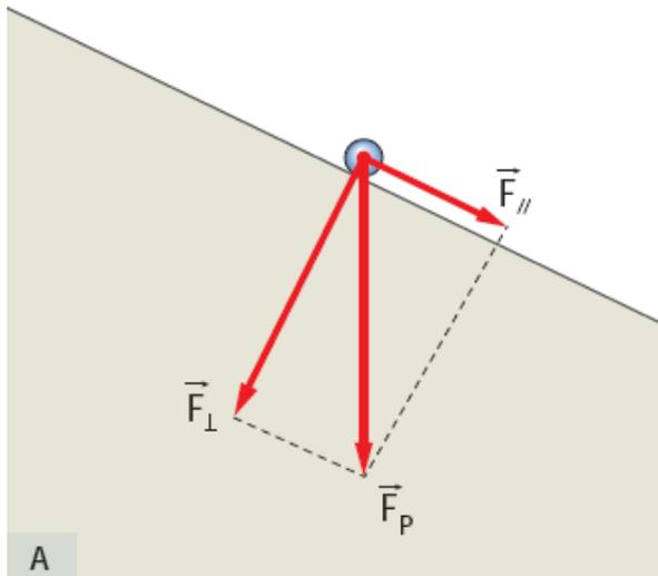
► Il vettore componente  $\vec{F}_\perp$ , perpendicolare al piano, è compensato esattamente da  $\vec{F}_V$ , perché il punto non si stacca dal piano.
