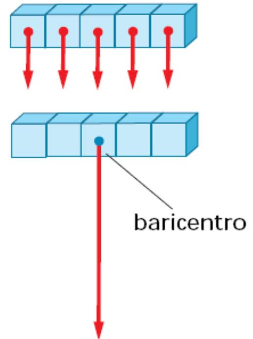
**Il baricentro o centro di gravità di un corpo rigido è il punto di applicazione della forza-peso, risultante delle piccole forze parallele applicate ad ogni volumetto del corpo.**
