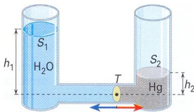
I due vasi comunicanti rappresentati in figura sono occupati in parte da acqua e in parte da mercurio. Sapendo che la densità del mercurio è di  $13\,600 \text{ kg/m}^3$  e che la sua altezza rispetto alla membrana scorrevole di separazione  $T$  è di  $25 \text{ cm}$ , determina l'altezza della colonna d'acqua necessaria per equilibrare quella di mercurio.
